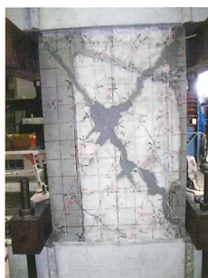
2 欠損部の修復状況 使用材料 IPH#600
