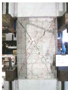
1 せん断破壊試験後状況(補修前) せん断破壊した柱状供試体 (AC-1)
