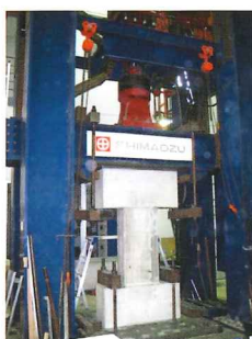
5 せん断破壊試験状況 建研式載荷装置
