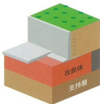
擁壁等の基礎
