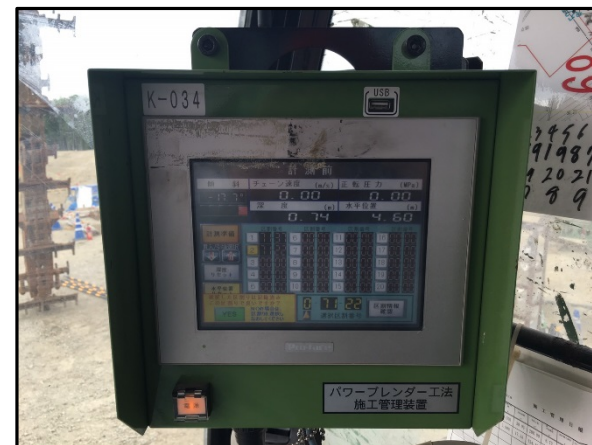
新施工管理装置
