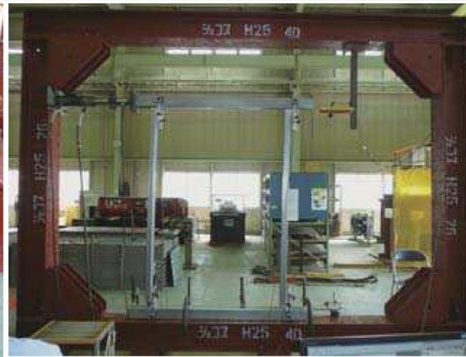
層間変位試験
