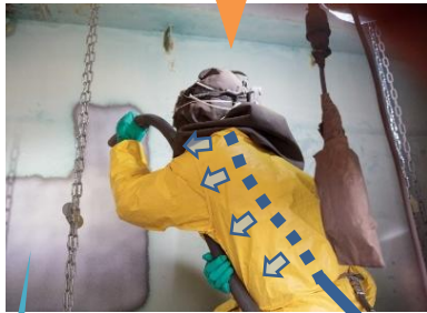
ブラスト作業中の送気状況 (防護フード及びスーツ内に 浄化空気が常に送気される)
