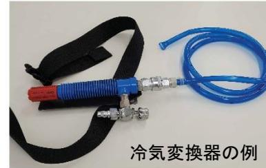
冷気変換器の例
