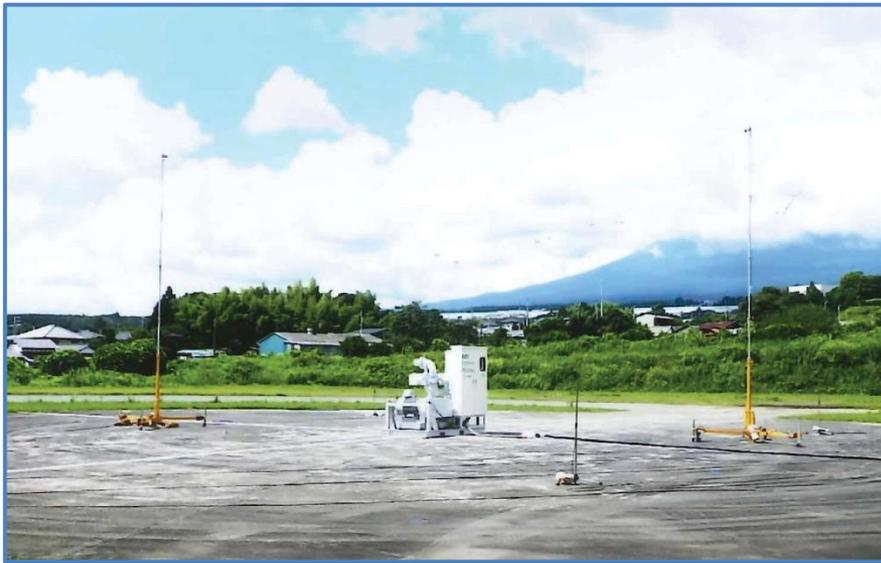
施工技術総合研究所の音響パワーレベル測定場での測定状況(55kw)
