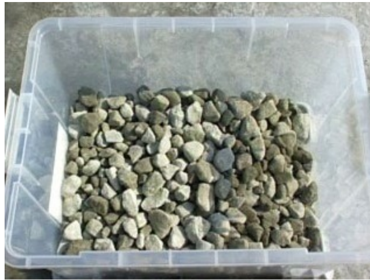
破碎後の製品（再生クラッシャー）
